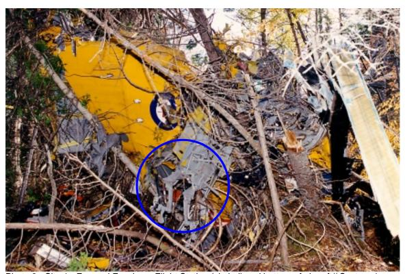
Photo 8 - Site 1 - Forward Fuselage, Flight Station (circled) and bottom of aircraft// Secteur 1 : fuselage avant, poste d'équipage (encerclé) et bas de l'appareil
