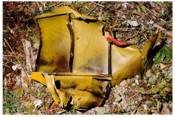
Photo 12 - Debris in Upper Field - Tunnel Cover Removed during first blade to fuselage strike (note soot on inside right)// Débris récupérés dans le secteur supérieur : carter du tunnel arraché lors du premier contact entre les pales et le fuselage (remarquez la suie sur le côté droit de la surface intérieure)
