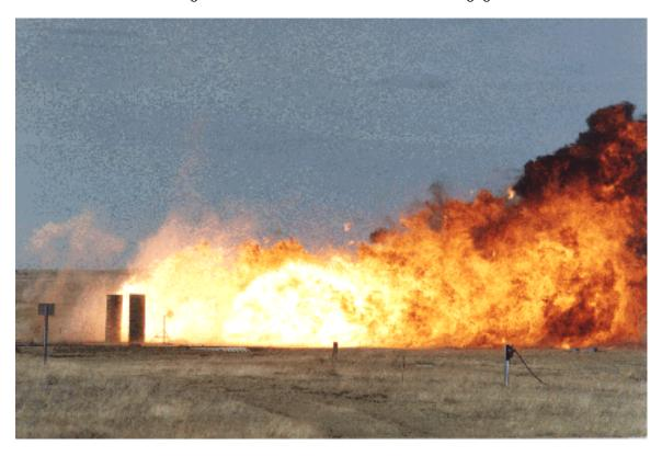
Photo 53 - DRES Experiment igniting simulated fuel dump cloud (under different conditions)// Expérience du CRDS visant à enflammer le nuage de carburant simulé à la suite d'un largage (dans des conditions différentes)
