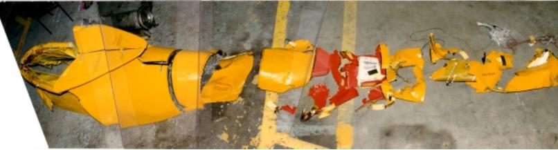
Photo 27 - Sync Shaft Tunnel Cover Re-build (exterior)// Reconstitution du carter du tunnel de l'arbre de synchronisation (extérieur)
