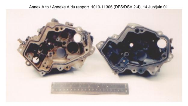
Photo 34 - Inside Views of #2 Engine Fuel Control Unit (left) and #1 FCU (right) - Note the lack of fuel residues on #2 // Vues de l'intérieur du régulateur de carburant du moteur numéro 2 (à gauche) et de celui du moteur numéro 1 (à droite); remarquez l'absence de résidus de carburant dans le FCU du moteur numéro 2
