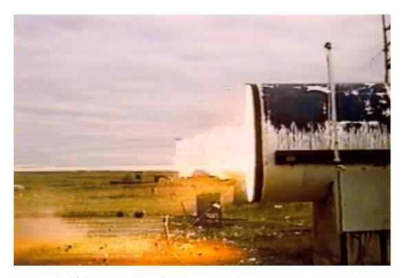
Photo 45 - DRES Engine Door Blast Experiment - Note flame emerge from structure (possible ignition source for fuels exterior of structure through vents) // Expérience du CRDS portant sur l'ouverture de la porte d'accès au moteur lors d'une explosion; remarquez la flamme qui sort de la structure (source d'allumage possible du carburant rejeté à l'extérieur de la structure par des mises à l'air libre)
