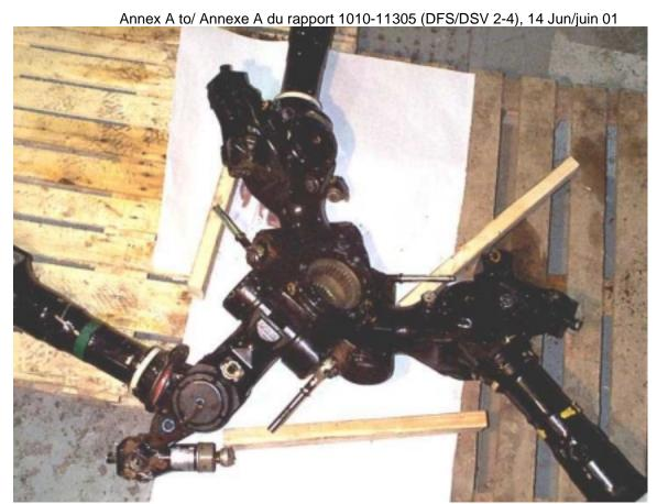
Photo 30 - Rear Rotor Head - Note Damper Failures in full extension// Tête du rotor arrière; remarquez les défaillances des amortisseurs en extension complète
