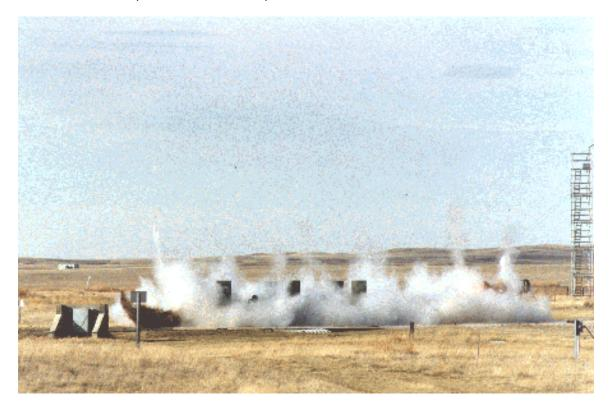
Photo 51 - DRES Experiment re-producing fuel dump cloud// Expérience du CRDS reproduisant le nuage de carburant résultant d'un largage
