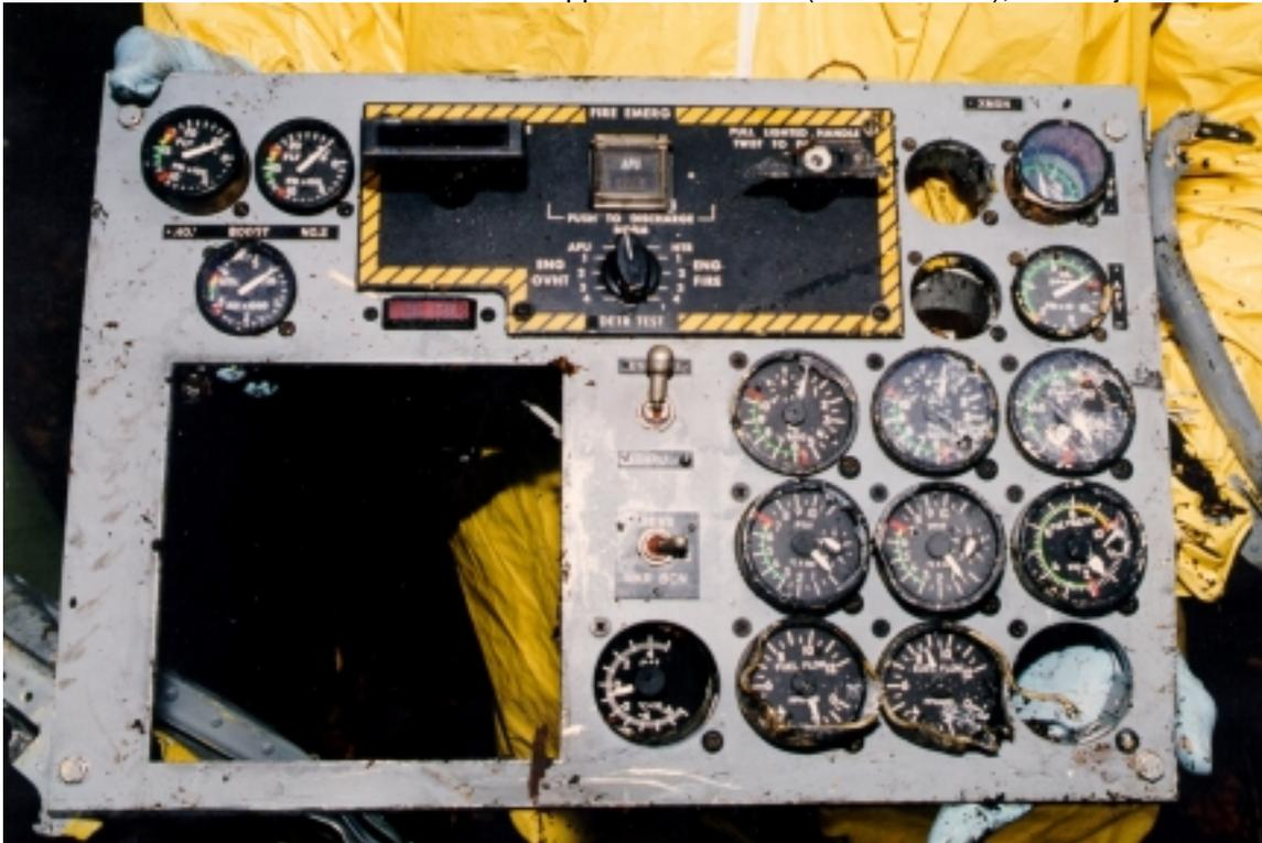
Photo 32 - Fire Extinguisher Control Panel - Note damage to Number 2 "T" handle// Panneau de commande du circuit d'extinction incendie; remarquez les dommages sur la poignée en T numéro 2
