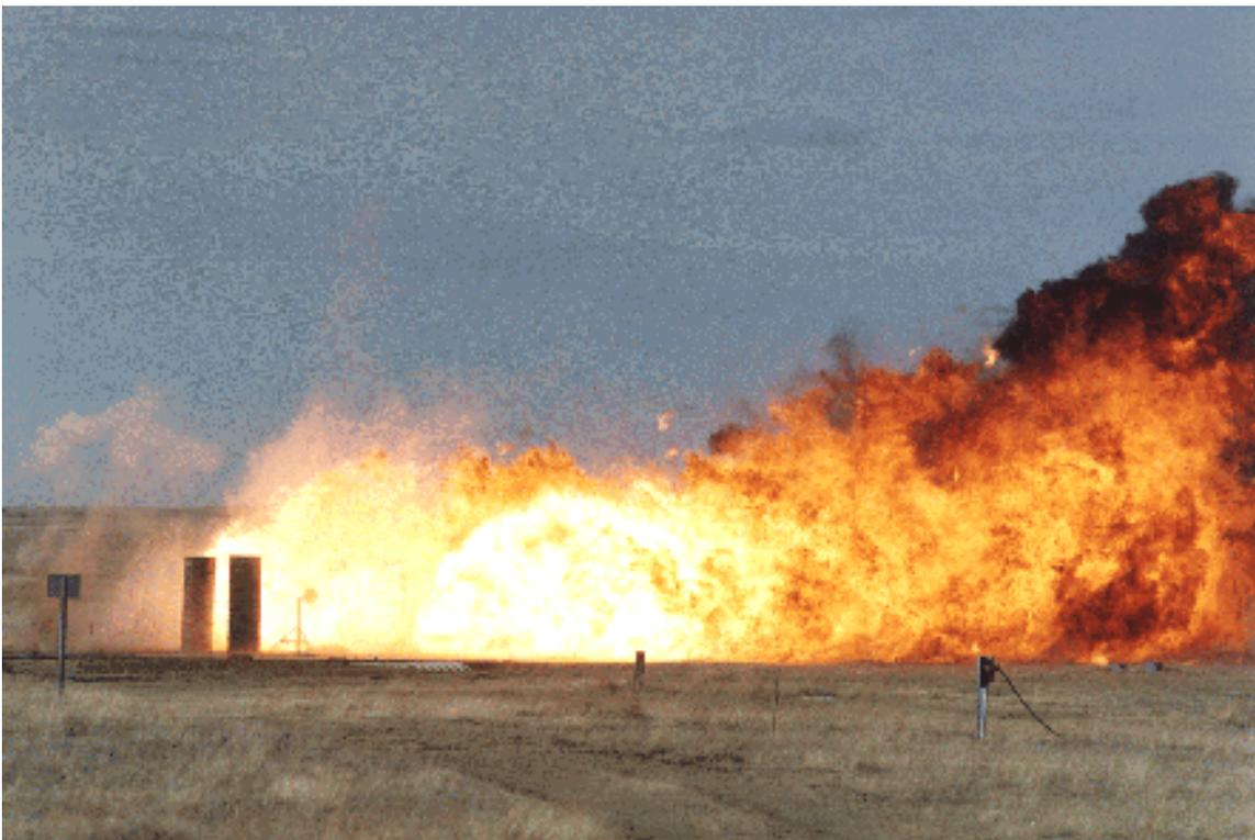
Photo 53 - DRES Experiment igniting simulated fuel dump cloud (under different conditions)// Expérience du CRDS visant à enflammer le nuage de carburant simulé à la suite d'un largage (dans des conditions différentes)
