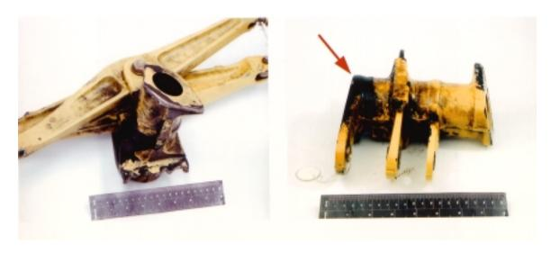
Photo 40/41 - Bell Crank Assembly - Note the signs of heating // Guignol; remarquez les dommages imputables à la chaleur
