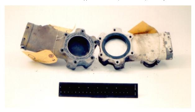
Photo 50 - Left and Right Fuel Dump valves (both in closed position)// Soupapes gauche et droite du vide-vite (toutes deux fermées)
