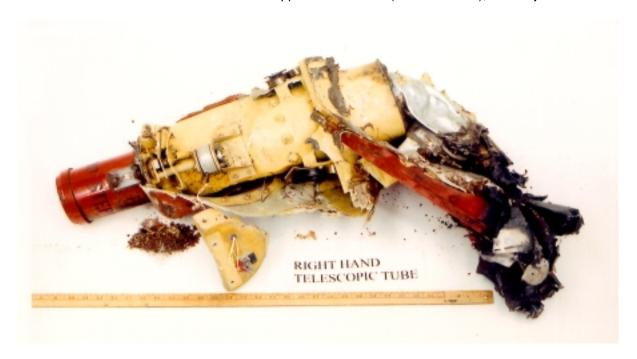
Photo 46 - Right Hand Fuel Dump Tube (retracted and confirmed)// Tube droit du vide-vite (rentré et confirmé)
