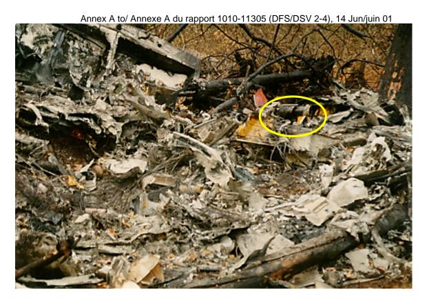
Photo 25 - Left Dump Tube as found on day 3 (retracted and circled)// Tube gauche du videvite tel qu'il était lorsqu'on l'a retrouvé au jour 3 des recherches (rentré et encerclé)
